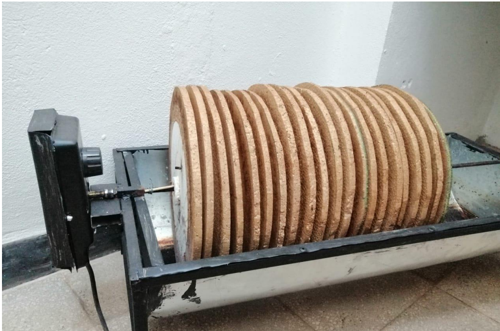
Figura 1. Reactor de biodiscos a escala laboratorio
